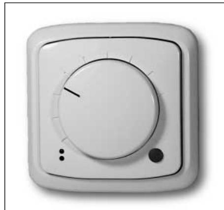
EX01 může mít mnohostranné využití. Do síťových proměnných poskytuje údaj o nastavení otočného knoflíku, údaj o stisku tlačítka a měřenou teplotu prostoru. Ze sítě je pak možno ovládat dvě signalizační LED diody. EX01 se dodává ve dvou modifikacích: EX01 a EX01A (s možností dynamického výběru periferie - viz popis periferií PES-EX).
