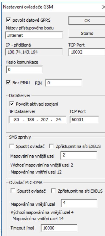
**povolit datové GPRS** – povolení spustit GPRS a tím zpřístupnit komunikátor na Internetu přes mobilního operátora
