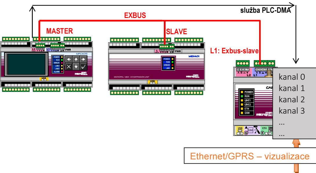
Linku L1 (komunikátoru CA5) je třeba nastavit na ovladač Exbus-Slave a v kartě ovladače Ethernetu nebo GSM povolit ovladač pro výměnu dat mezi zařízeními tzv. PCL-DMA
