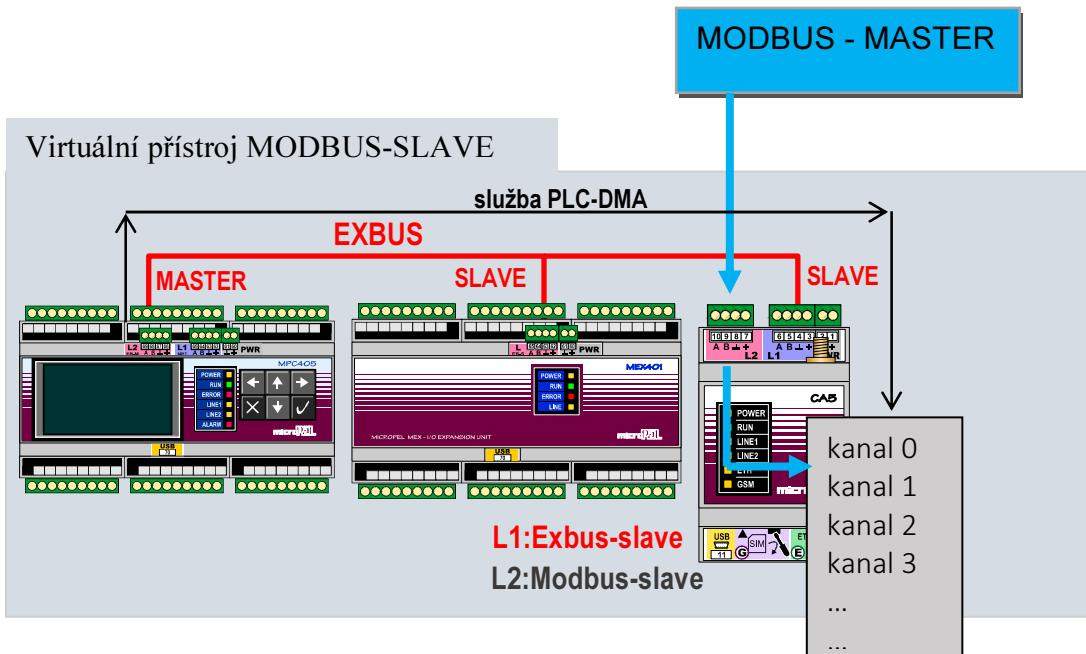
Linku L1 je třeba nastavit na ovladač Exbus-Slave a linku L2 nastavit na ovladač Modbus-Slave včetně s tím souvisejících parametrů.
