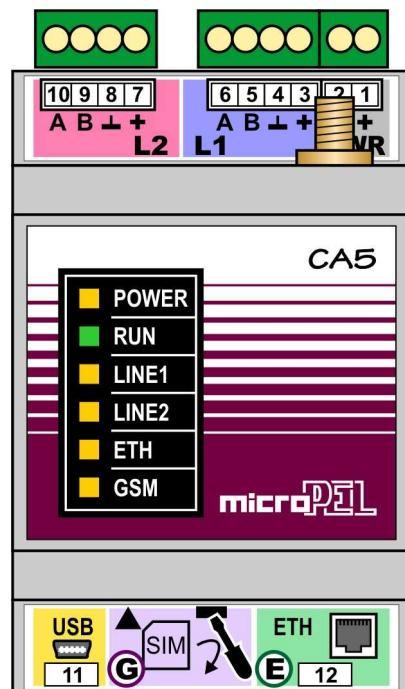
Komunikátor CA5 je předurčen pro nasazení jako univerzální připojovací bod sítě automatů MICROPEL a to rozhraním USB, Ethernet nebo GPRS. Komunikátor CA5 může realizovat výměnu dat mezi automaty, které jsou lokalizovány v různých sítích automatů. Tato výměna dat (funkce PLC-DMA) je řízena vybraným automatem v jedné síti a protilehlé sítě jsou identifikovány IP adresou komunikátorů CA5 v těchto sítích. Výměna dat může probíhat jak přes rozhraní Ethernet tak GSM.
