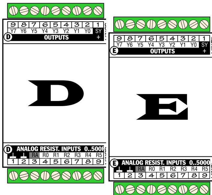
Moduly jsou určeny pro měření teploty pomocí odporových teplotních čidel, resp. pro přímé měření odporu.
