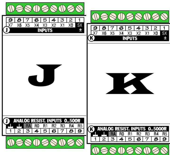
Moduly jsou určeny pro měření teploty pomocí odporových teplotních čidel, resp. pro měření odporu. Konstrukčně vycházejí z modulů D a E, od kterých se liší jen tím, že obsahují 8 digitálních vstupů namísto osmi digitálních výstupů a dovolují tedy mnohem lépe přizpůsobit konfigurace automatů řady MPC300 pro různé aplikace s různým poměrem digitálních vstupů a výstupů.
